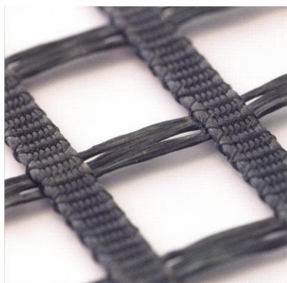
2. ábra. Raschel-gépen kötött georács
