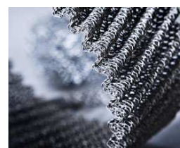
9. ábra. Fémhuzalból kötött gépkocsi katalizátor betét
