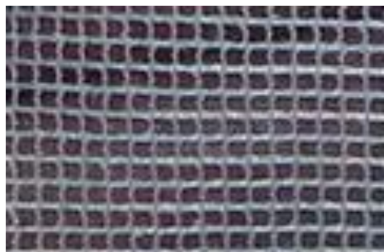
5. ábra. Rács szerkezetű árnyékoló fügönyanyag (Swiss Shield) [12]
