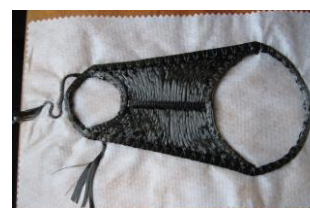
Kompozit gépalkatrész textil-erősítése hímzőgépen előállítva
