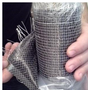
Szénszál kompoziterősítő a Puli holdjáróhoz [4]
