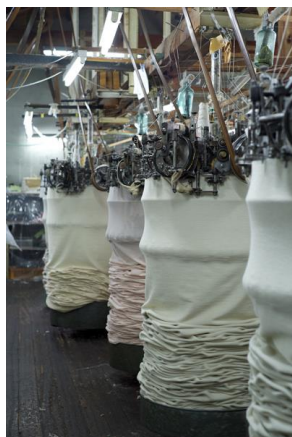
1. ábra. Francia rendszerű körhurkológépek egy üzemben [8]
