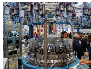
Mec-Mor Variatex – Változtatható tűszámú körkötőgép
