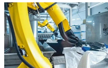
16. ábra. Mosodai hajtogatórobot (Fanuc-Swets) [18]
