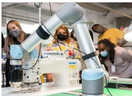
12. ábra. Sewbo varrórobot [12]
