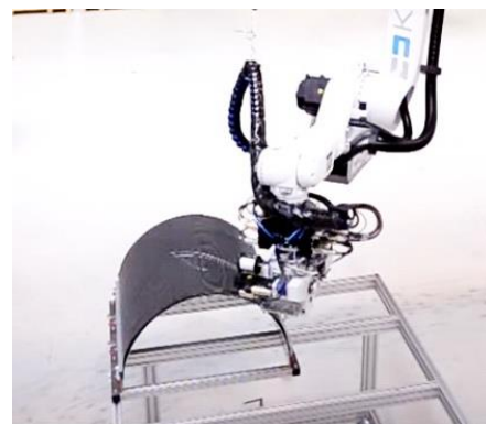
14. ábra. 3D varrástechnika alkalmazása egy hengeres alakú alkatrész külső és belső felületén (Pfaff) [13]
