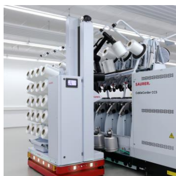
7. ábra. Saurer AGV csévéfelrakó robot
