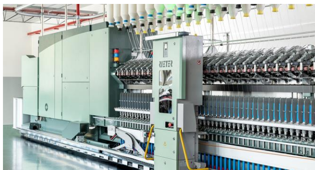
6. ábra. Rieter ROBOSpin fonalszakadást kijavító robot
