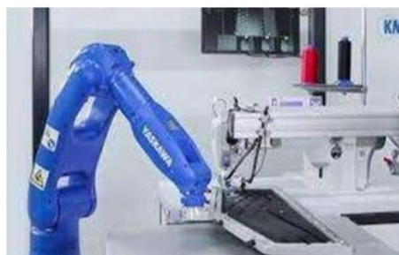
13. ábra. SewBot varrórobot (KMF) [12]
