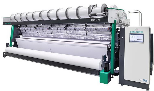
9. ábra. Karl Mayer gyártmányú, elektronikus vezérlésű lánchurkológép [8]
