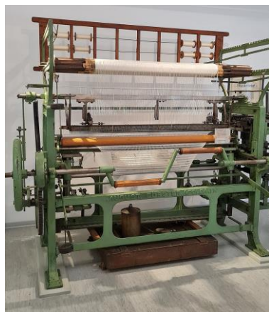
10. ábra. Raschel-gép 1928-ból [16]
