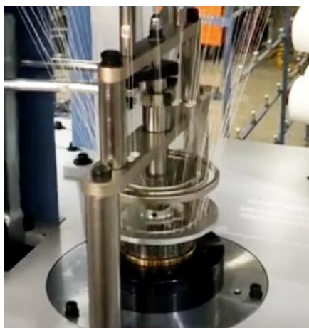
13. ábra. Kis átmérőjű láncrendszerű körkötőgép részlete (Rius)
