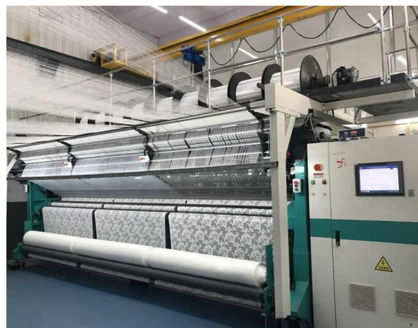
11. ábra. Korszerű, csipkekészítésre szolgáló raschel-gép (Karl Mayer) [8]
